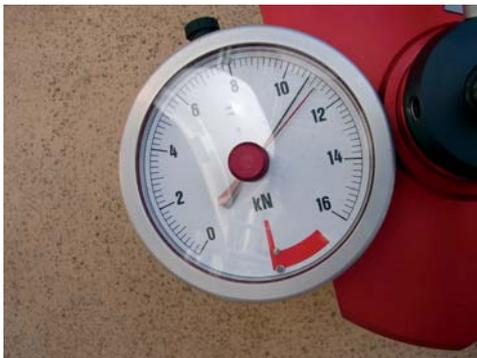
Fig. 3 – Lecture directe de la capacité de traction sur l'appareil de contrôle
