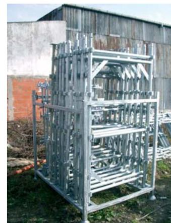
Fig. 34 Rack de stockage pour les éléments d'échafaudage
