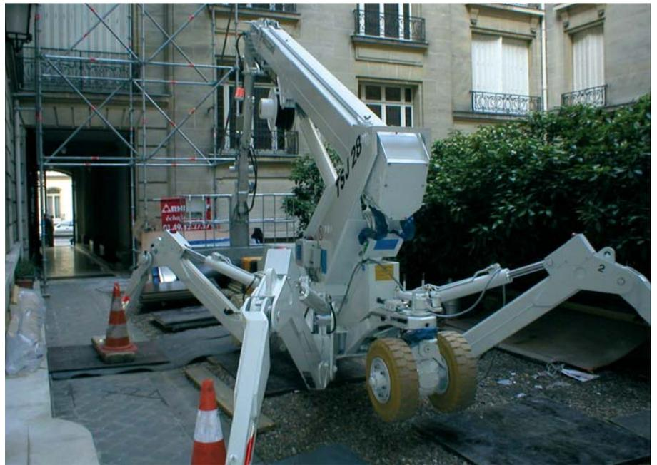
Fig. 24 – PEMP installée dans une courette
